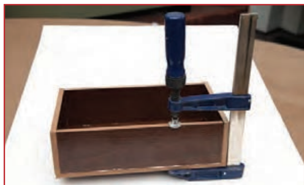
شکل ۹-۱۶. بستن جعبه به وسیله پیچ دستی
