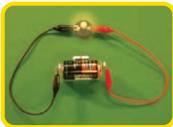
شکل ۵- مدار الکتریکی ساده
