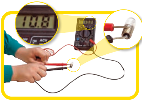
شکل ۸- اندازه‌گیری مقاومت لامپ خاموش با اهم سنج
